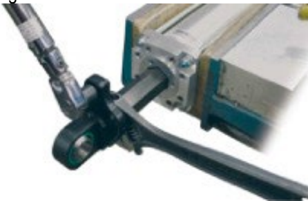
Figura 4.4: En el caso de la varilla hexagonal, mantenga fija la varilla de empuje utilizando una llave en la parte plana de la varilla cuando fije los accesorios, los enlaces o la carga al actuador. Utilice una llave dinamométrica para apretar el extremo de la varilla de interconexión al punto de conexión roscado del actuador. Valores de par de apriete indicados en la Tabla 4.1
